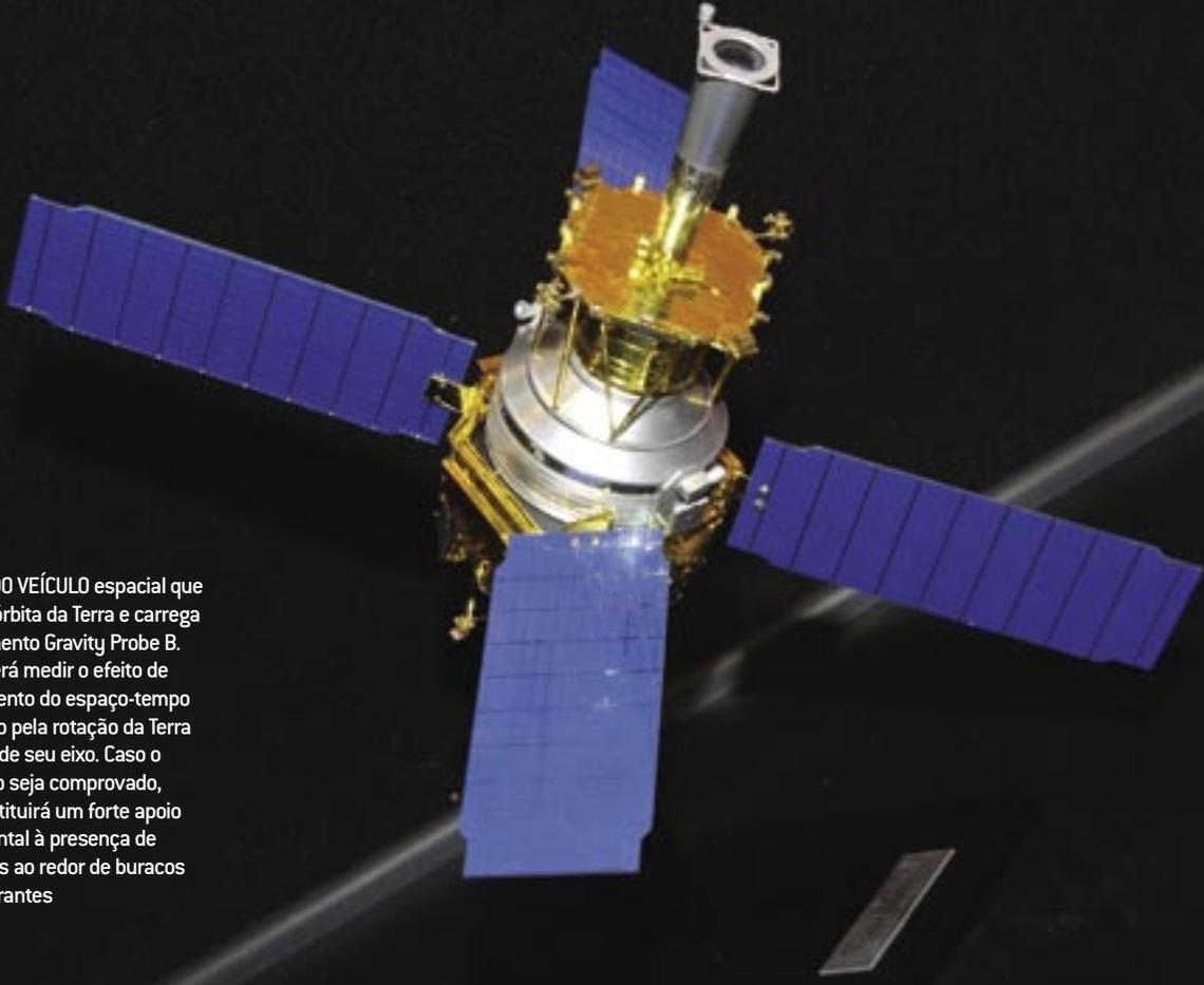
IMAGEM DO VEÍCULO espacial que está em órbita da Terra e carrega o experimento Gravity Probe B. Este deverá medir o efeito de arrastamento do espaço-tempo provocado pela rotação da Terra em torno de seu eixo. Caso o fenômeno seja comprovado, isso constituirá um forte apoio experimental à presença de ergosferas ao redor de buracos negros girantes
